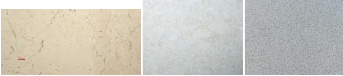
Figura 18. Esempi di lavorazione della pietra di Trani: lucidata, levigata, bocciardata
